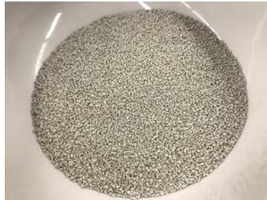
**Fig. 2.5.** Organo-modified bentonite (mesh 40-14)
